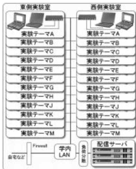
図7.1 ネットワーク環境を利用した場合のWeb学習教材の配信システム
