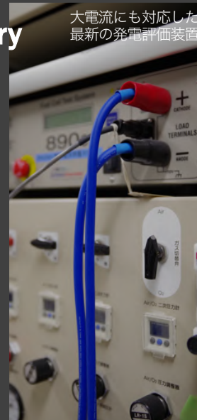
専用設計の燃料電池評価用ガス供給装置
