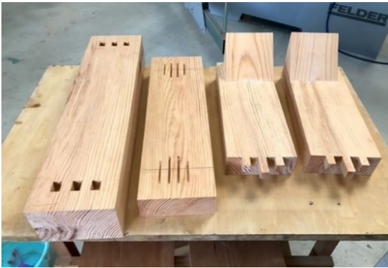
図7 獅子台座の框枠組の仕口
