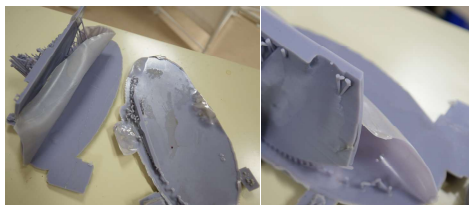
図 22 下層と遷移層の結着不良により積層が剥離した成型物
