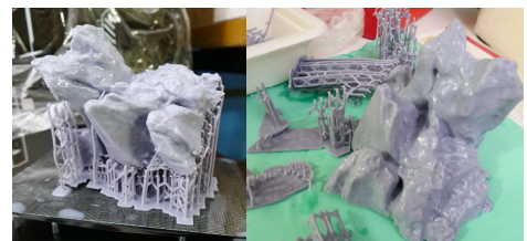
図 6 光レジン 3D プリンタによる成型出力
