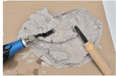
図25 リユーターや切削工具による成型物の加工
