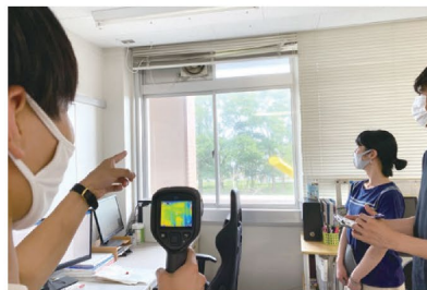
サーモグラフィによる温熱環境計測
