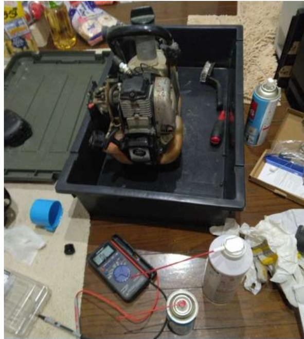
図 8 エンジンポンプの分解整備の様子
