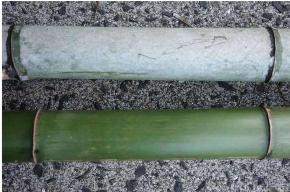
図03 切り出した竹(上)と油抜き後の竹(下)
