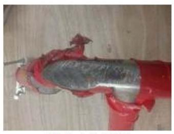
図 11 ロールバー損傷部分
