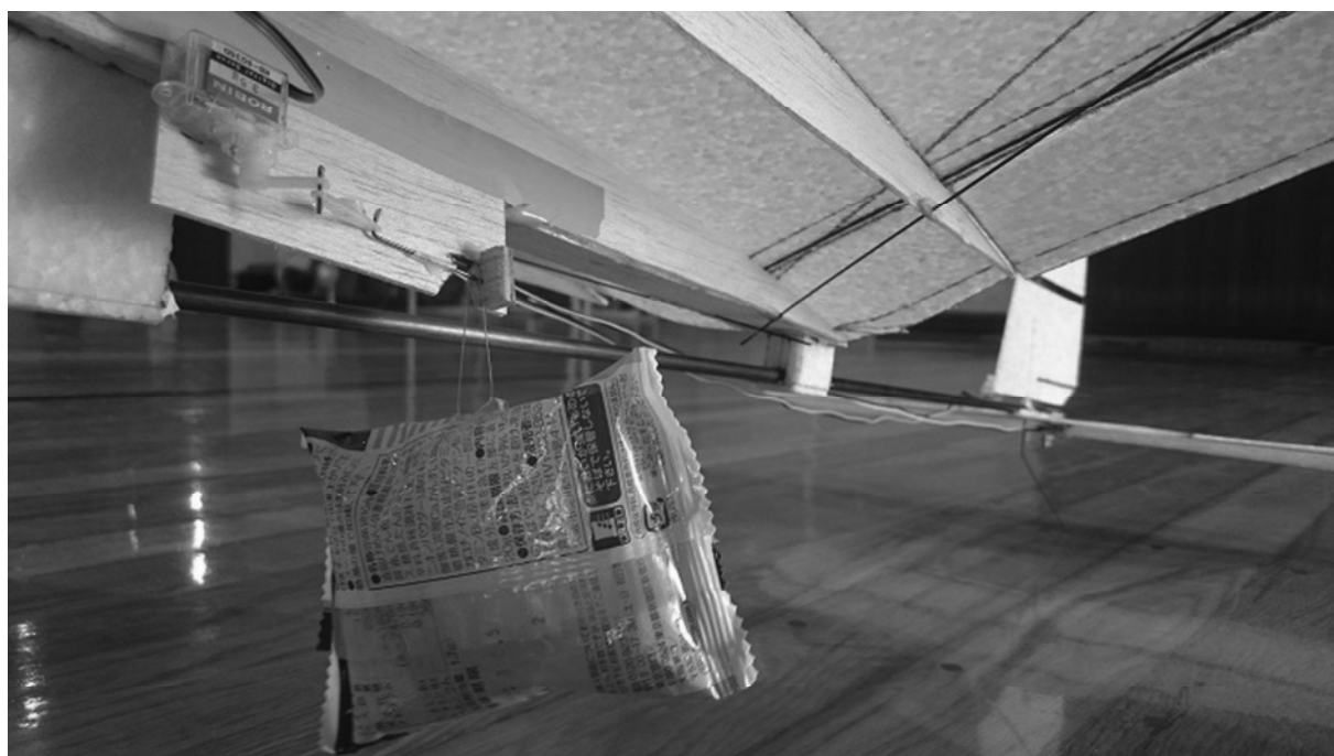
写真7 改良後の投下機構
