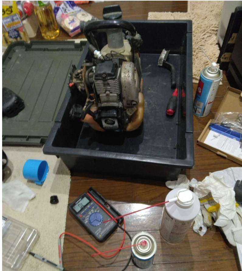
図 8 エンジンポンプの分解整備の様子
