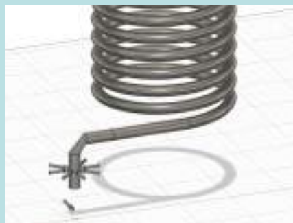
バイオマスバーナーの 過熱水蒸気生成部
