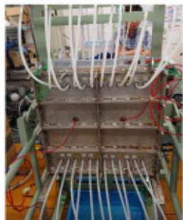
開発した世界最大膜面積を有するREDスタック
