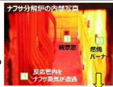
約850℃でナフサ熱分解している炉の熱源をアンモニアに転換
